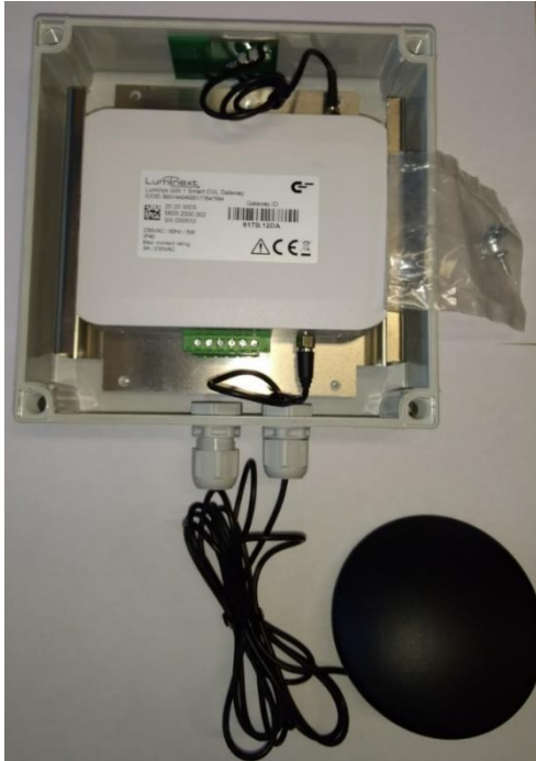
Afbeelding: voorbeeld kastmontage
